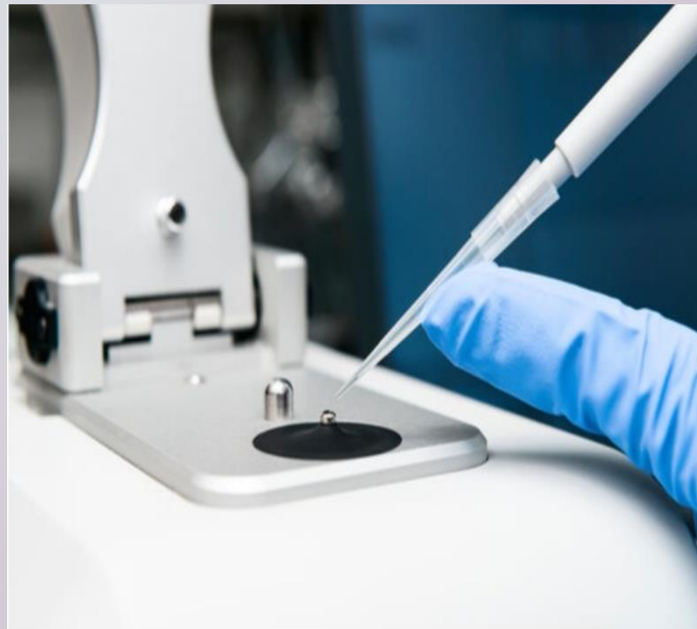
کیفیت DNA استخراج شده با نانو دراپ بررسی می شود
