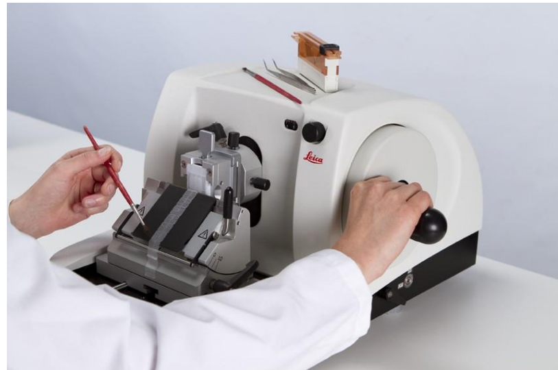
دستگاه میکروتوم برای برش گیری نمونه های نگهداری شده در پارافین
