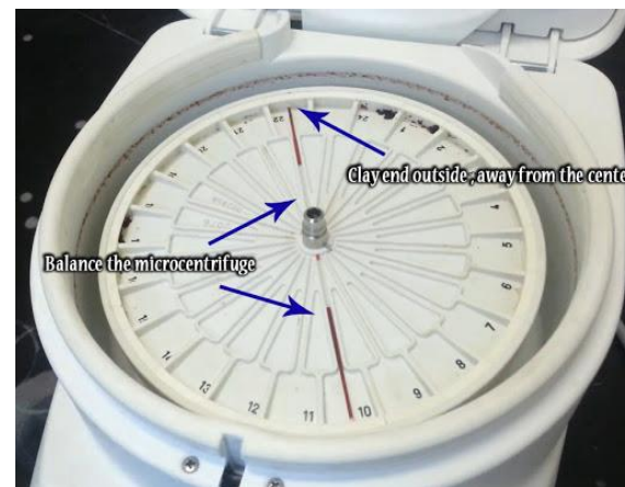
روش چیدن لوله های هماتوکریت در دستگاه میکروسانتریفوژ هماتوکریت
